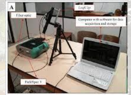
Caracterización nutricional de semillas mediante NIRS (FieldSpec 4)
